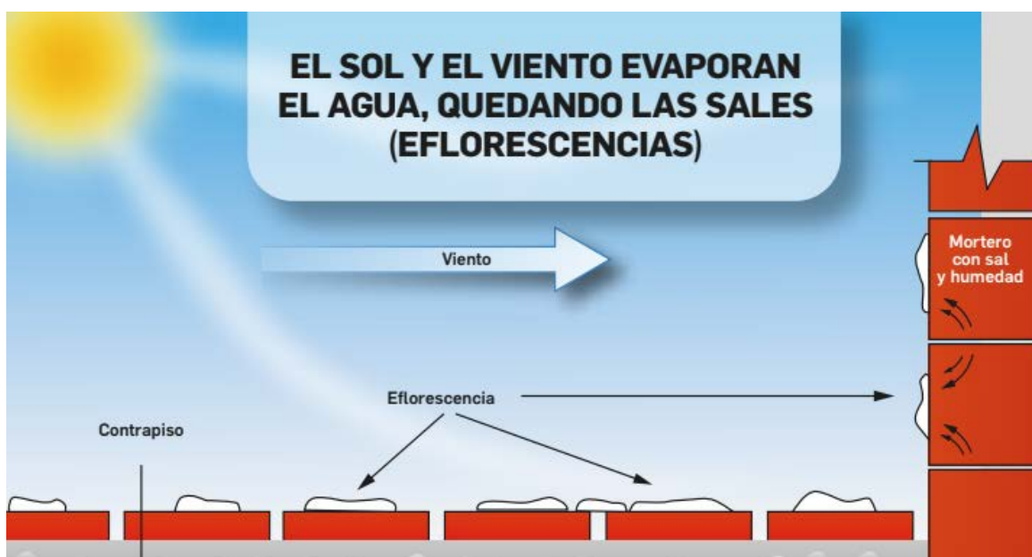
Figura 2.5. Mecanismo de eflorescencia.
