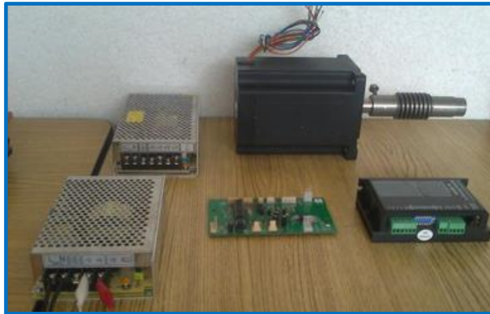
Figura 3.19: Motor a pasos y componentes del sistema de control
