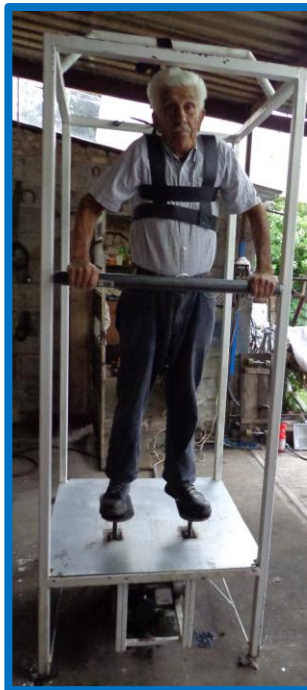
Figura 4.3: Prototipo de la marcha utilizado por una persona de la tercera edad
