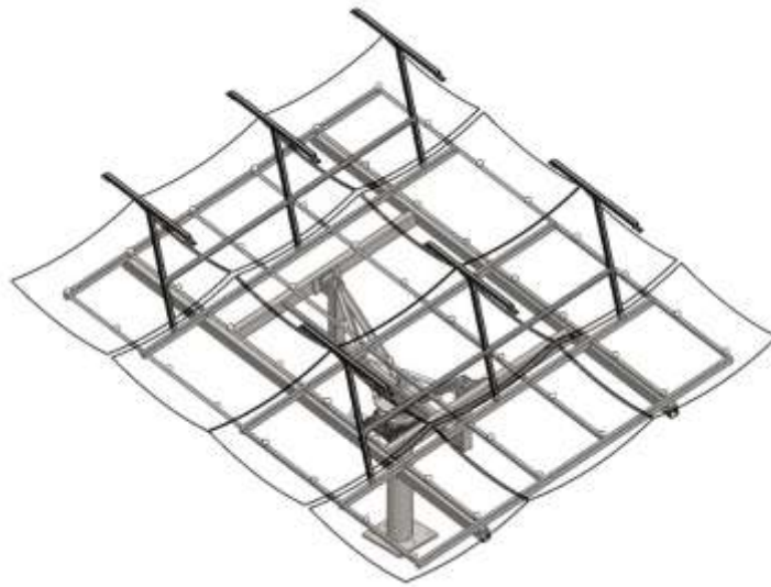
Figura 3.1 Modelo virtual final del seguidor solar.
