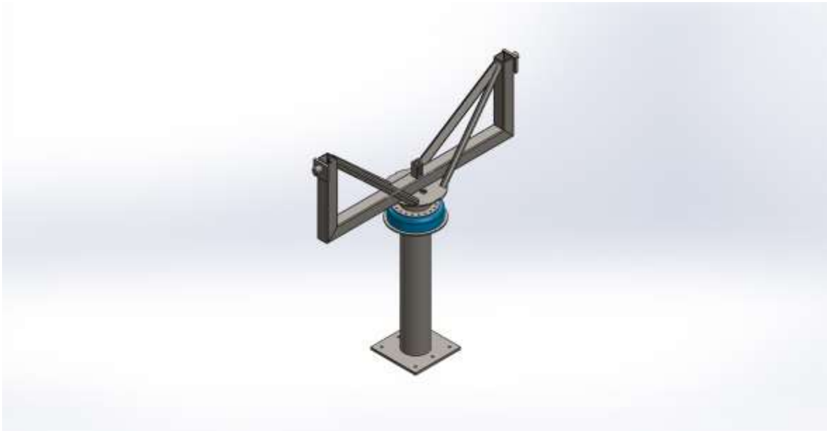
Figura 4.9 Ensamble del diseño de la base del seguidor.
