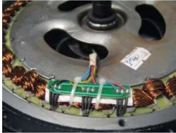
FIGURA 3.3 Ejemplo de sensor efecto Hall en motor brushless [16].
