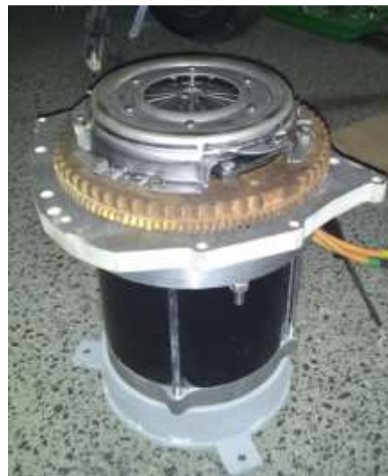
FIGURA 1.11 Clutch acoplado al volante de inercia [19].
