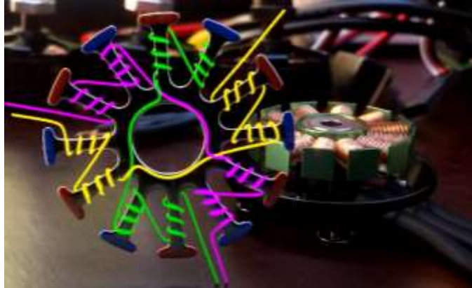
FIGURA 3.2 Ejemplo de embobinado de un motor brushless [17]
