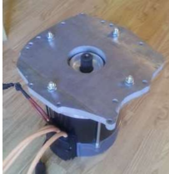
FIGURA 1.10 Placa base acoplada al motor eléctrico [19].
