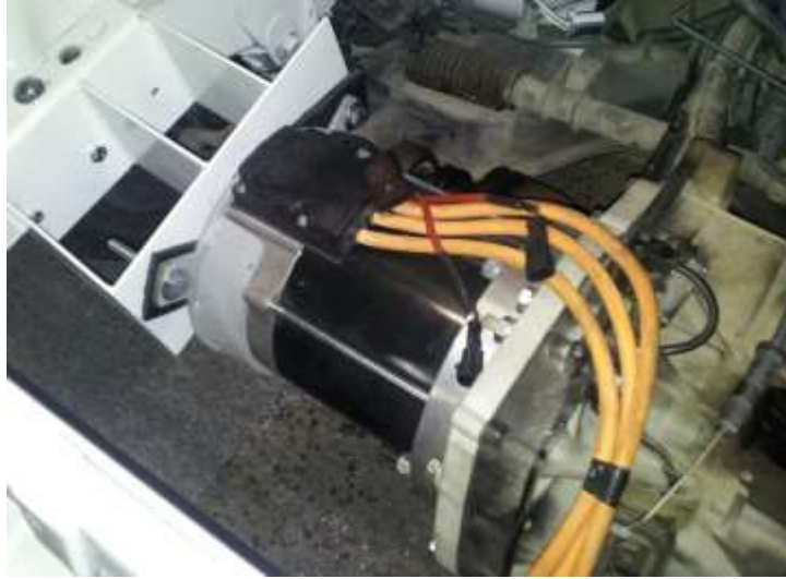
FIGURA 1.12 Ensamble final de un motor eléctrico a la transmisión [19].
