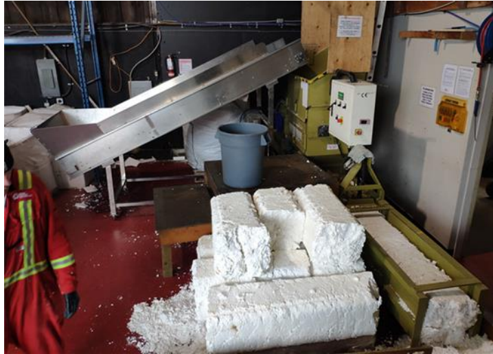
Figura 3.7 Compactación por tornillo.
