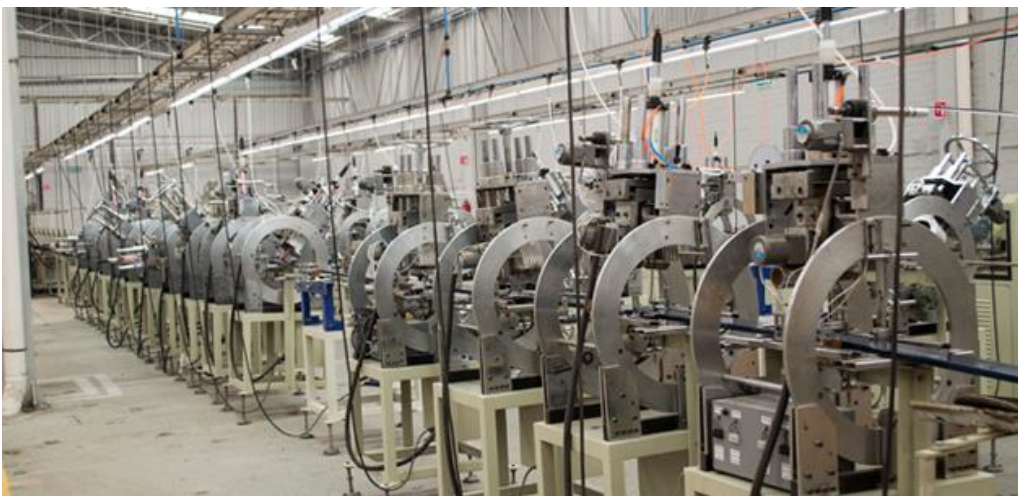
Ilustración 3.5 Proceso de extrusión de molduras para marcos.
