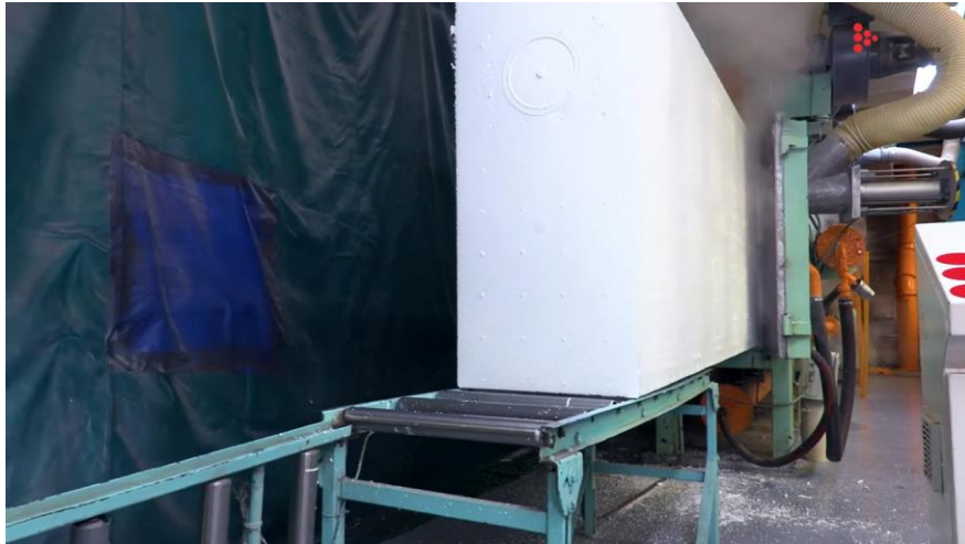
Figura 3.10 Moldeado por vapor de bloques de construcción.
