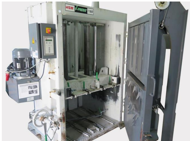
Figura 3.8 Compactadora hidráulica vertical.
