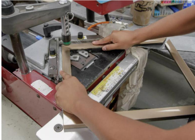
Figura 3.6 Ensamble de marcos reciclados con uniceL.
