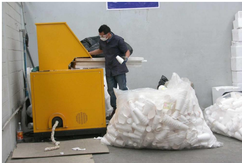
Figura 2.6 Proceso de fusión de residuos de EPS.
