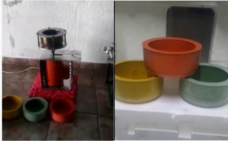
Figura 3.12 Centrifuga para realizar macetas por roto moldeo.
