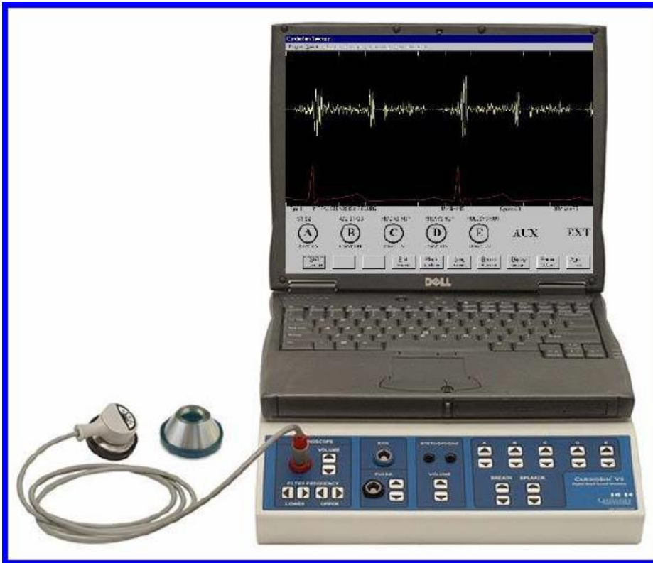
Figura 23 Analizador fonocardiográfico automatizado que se basa en la ecualización acústica multicanal. Este módulo se usa también como un simulador para entrenamiento de auscultación cardíaca. [Cardionics Inc. para estetoscopio digital]
