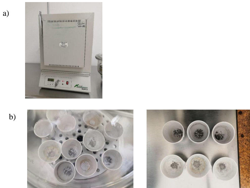
Figura 10. Determinación de cenizas. a) Muestras en mufla a 550°C (foto de las autoras) y b) Muestras en cenizas (foto de las autoras).
