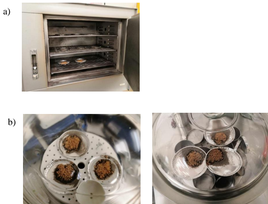
Figura 8. Determinación de humedad. a) Muestras húmedas y b) Muestras secas (fotos de las autoras).
