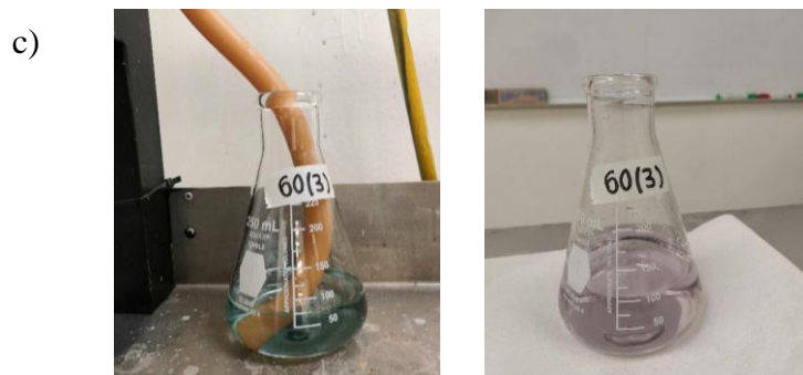
Figura 14. Determinación de proteína. a) Digestión (foto de las autoras), b) Destilación (foto de las autoras) y c) Cambio de color (foto de las autoras).
