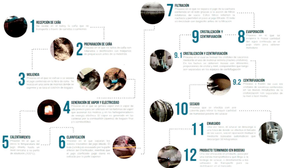
Ilustración 2. Proceso de recepción y molienda de la caña de azúcar en los ingenios cañeros de México.
