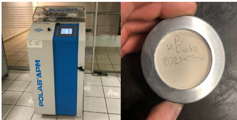
Figura 3.8. Equipo de prensado APM y tableta de muestra.
