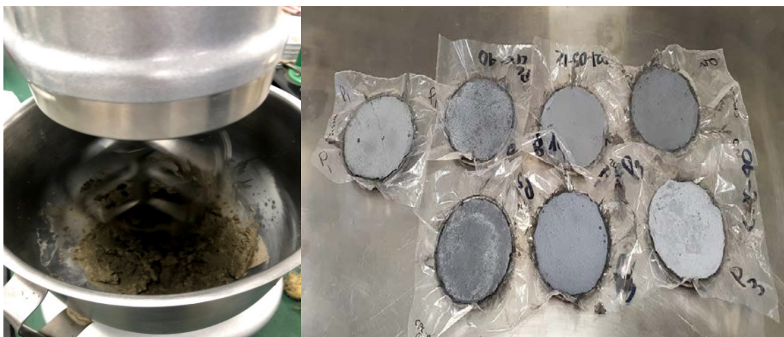
Figura 3.13. Mezcladora industrial y placas de cemento.
