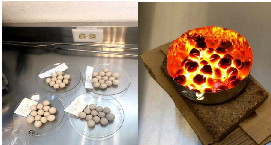
Figura 3.12. Nódulos de Harina Cruda y Clinker de laboratorio.
