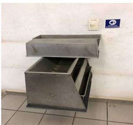
Figura 3.4. Cuarteo de material.
