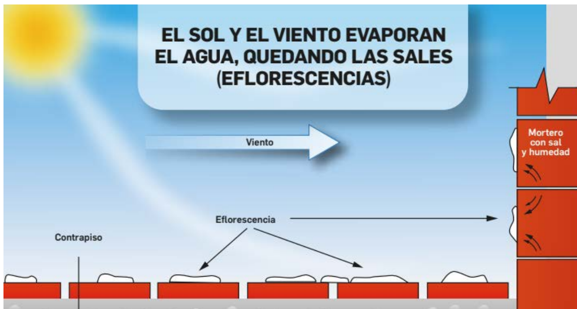
Figura 2.5. Mecanismo de eflorescencia.
