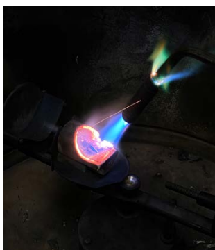
Figura 52. Colado del metal
