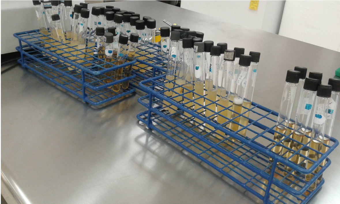
Figura 10. Crecimiento de las bacterias encapsuladas en distintos pH (6.20, 5.62, 5.22, 4.31, 4.07, 3.50, 3.18, 2.51, 2.22, 1.50) en agar MRS.
