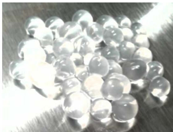
Figura 18. Obtención y selección de perlas con la forma esférica
