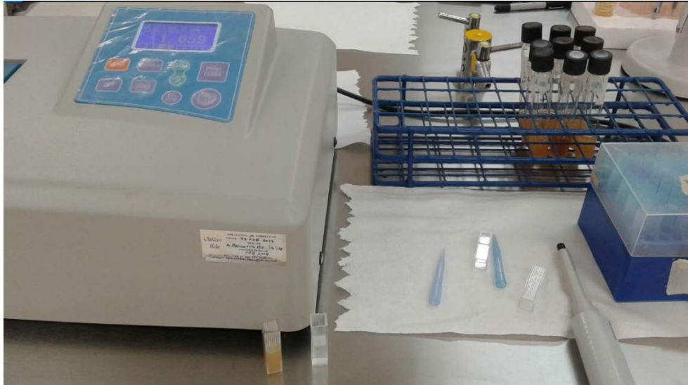
Figura 11. Determinación de viabilidad durante 30 días por triplicado de bacterias encapsuladas: L. casei shirota , L. leichmanni , B. tequilensis , mediante un espectrofotómetro (C304) Modelo -500 UV Serie N° AE1407042., WL: 560nm.
