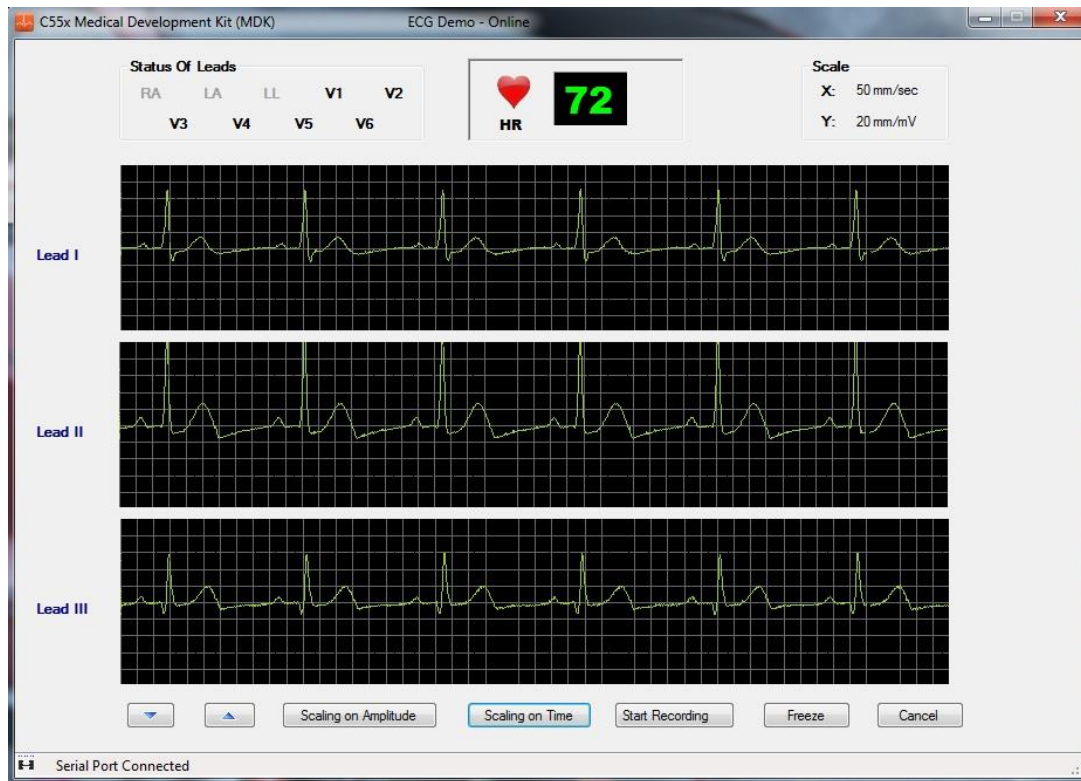
Figura 3.5 Ventana principal del programa ejecutable de Texas Instruments para monitoreo de señales ECG con el DSP TMS320C5515
