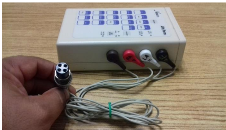
Figura 3.28 Colocación de los electrodos al simulador de paciente LF03670.
