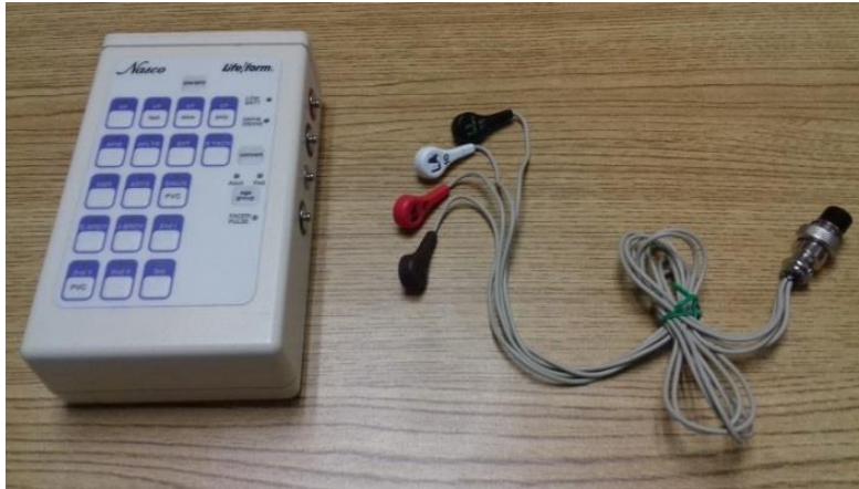
Figura 3.27 Conexión simulador de paciente LF03670 y el cable adaptador con cuatro electrodos.
