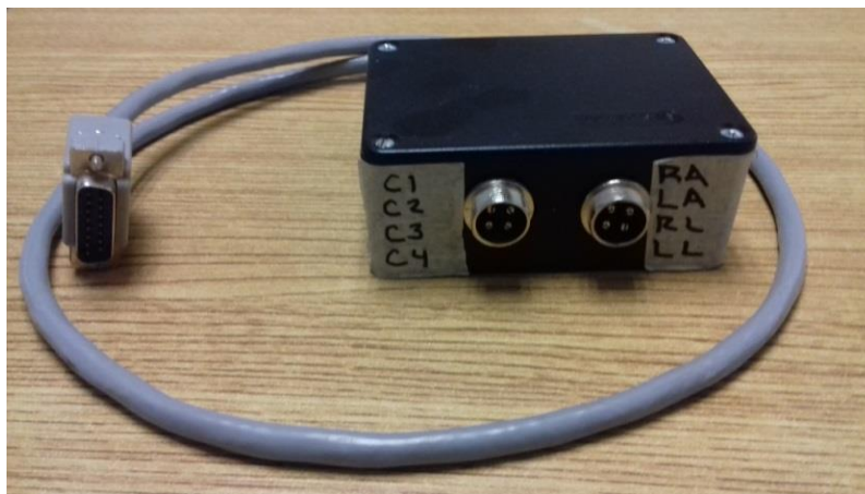
Figura 3.25 Cable adaptador realizado con conector DB15. Fuente: Imagen tomada directamente.
