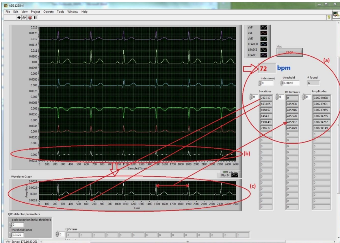
Figura 4.6 Panel Frontal de programa desarrollado en LabVIEW para lectura de señales ECG desde la tarjeta ADS1298ECG-FE para las derivaciones I, II, III.
