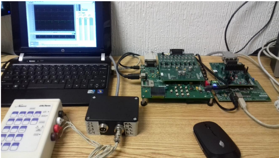
Figura 4.12 Sistema completo, simulador de paciente LF03670, PC con software LabVIEW y las dos herramientas de adquisición de datos de Texas Instruments.
