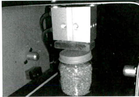
Estación de tapado y sellado
