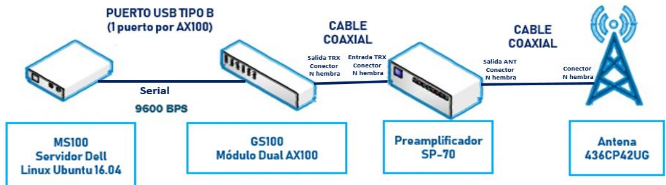
Figura 8.2. Diagrama de conexión entre MS100 y GS100.
