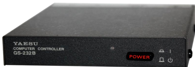
Figura 5.12. Controlador del Rotor YAESU-232 B.
