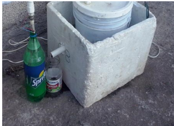
Figura 1.2: Biodigestor 20 L. Fuente (propia)
