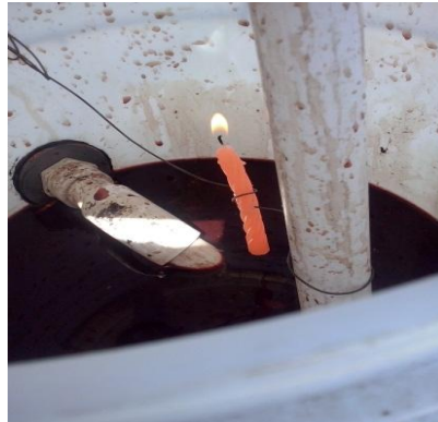
Figura 4.5: Llenado inicial del biodigestor Fuente: Diseño propio.
