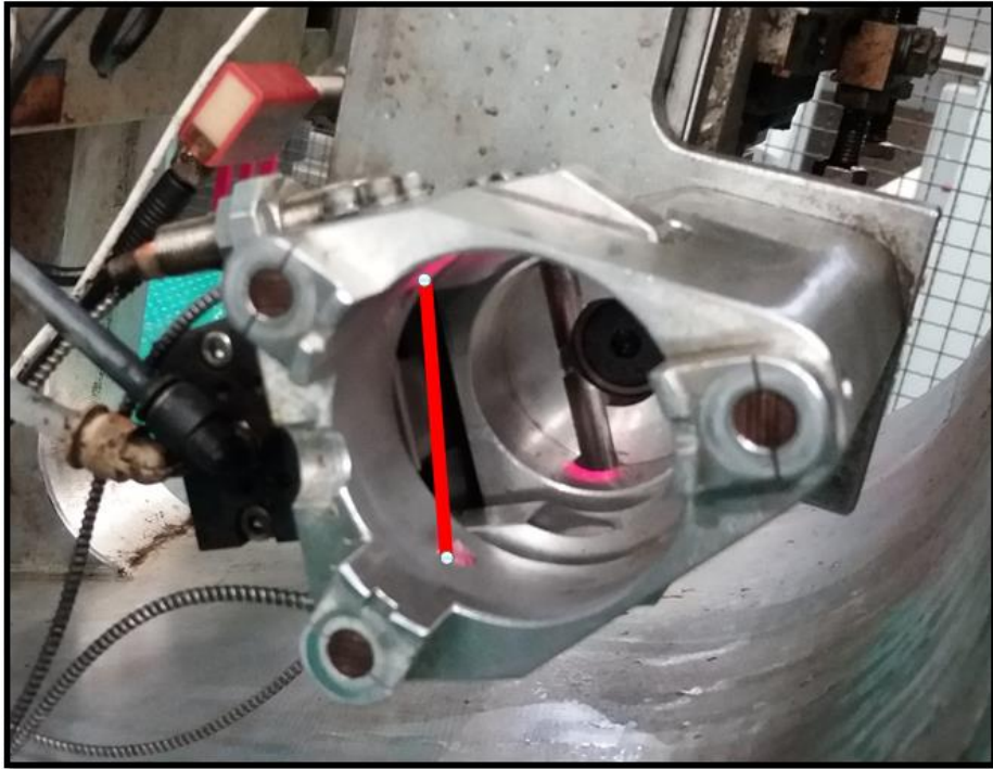
Figura 23. Fibra óptica mal colocada en la pinza.
