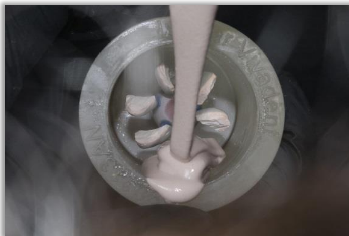
Fig. 26. Colocación de revestimiento en el cilindro de silicona
