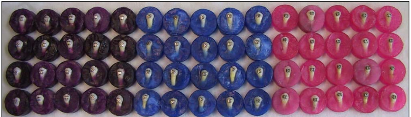
Fig. 11 Premolares embebidos en acrílico. Grupo de izquierda a derecha: malla supermesh, Gemini y 100.
