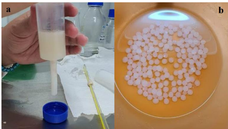
Figura 10. a) Proceso de encapsulación b) Encapsulados en solución de cloruro de calcio 0.1M
