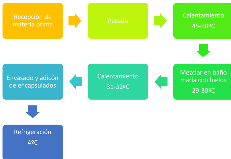
Figura 7. Diagrama de atemperado por baño maría inverso
